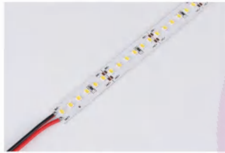
欧司朗灯珠硬灯条 电压：直流DC12V/24V(可选) 功率：16W/米 灯珠：2835 144珠/米 宽度：12mm 长度：1000mm 色温：3000K/4000K/6000K 显指：RA90
